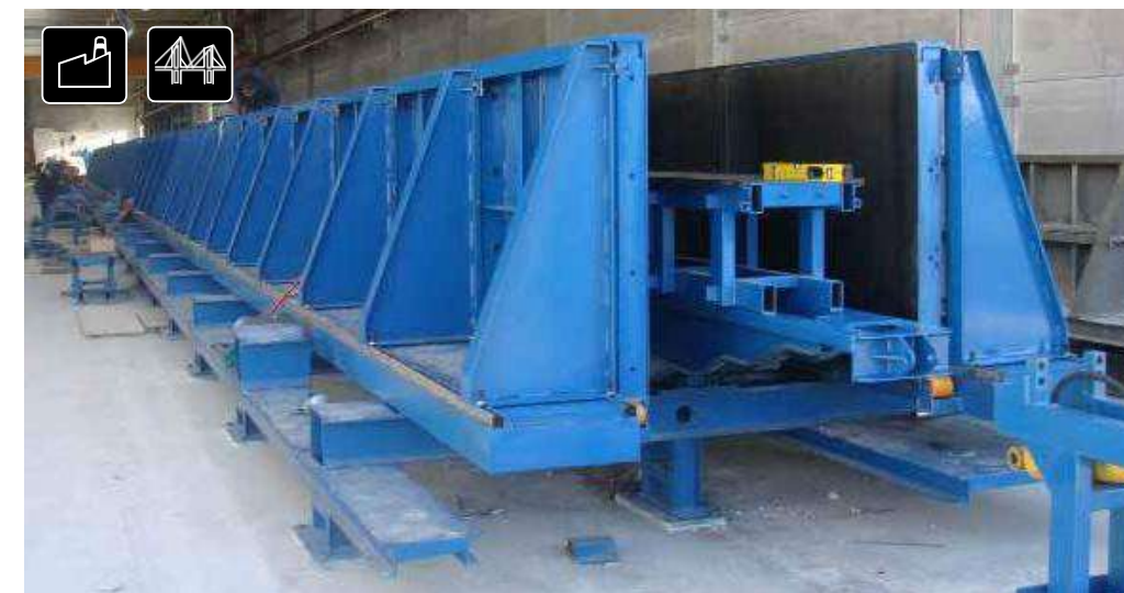
Переналаживаемая форма для изготовления колонн
