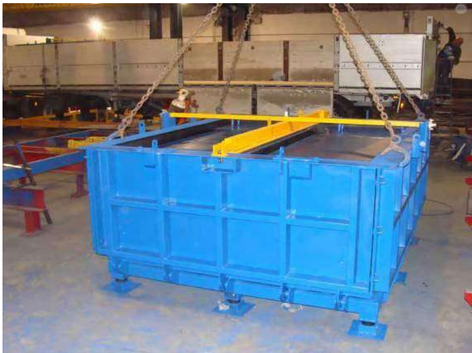
Форма для производства лотков
