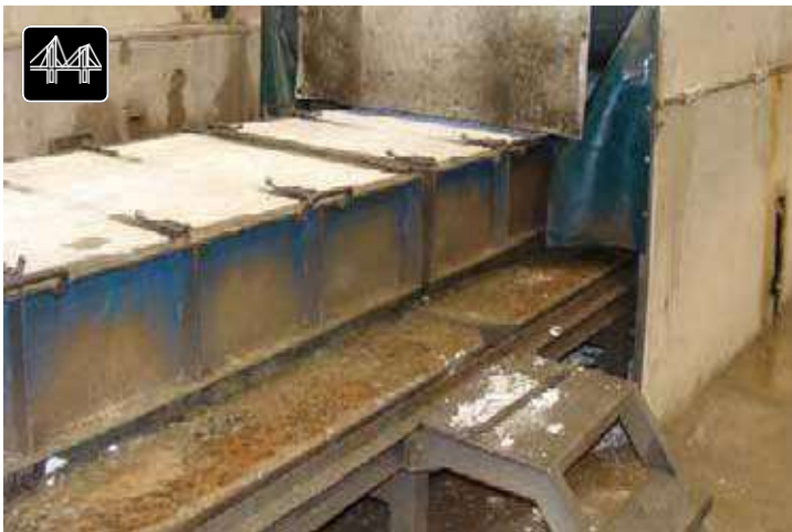
Перемещение форм с отформованными изделиями на пост ТВО
