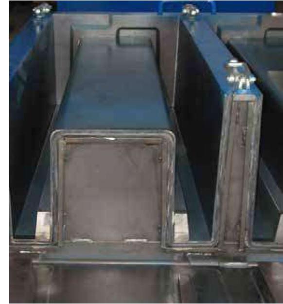
Форма для производства электротехнических лотков
