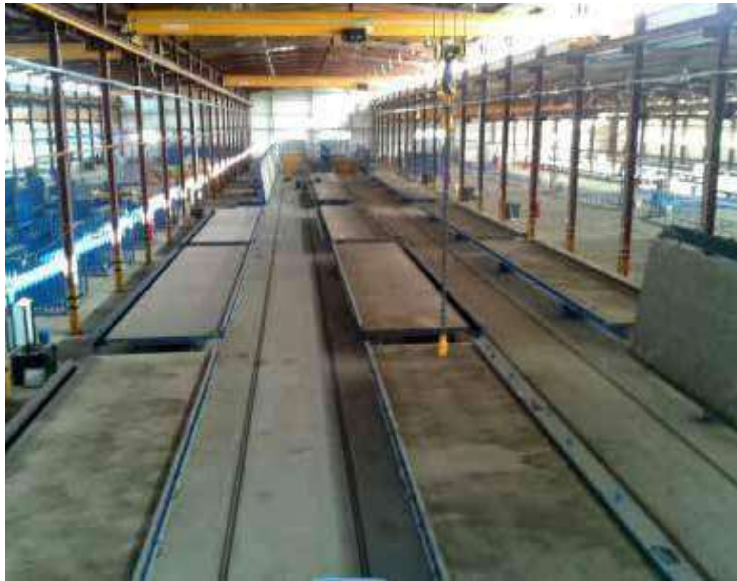
Домостроительный комбинат производительностью 4 000 домов социального типа в год. Цех производства стеновых и перегородочных панелей.
