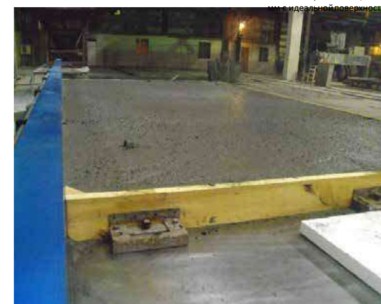
Лист металлопокрытия толщиной 10 мм с идеальной поверхностью
