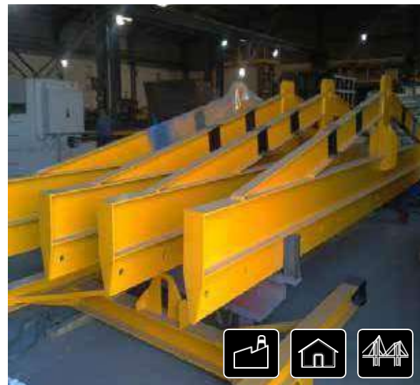
Подъёмные траверсы для панелей
