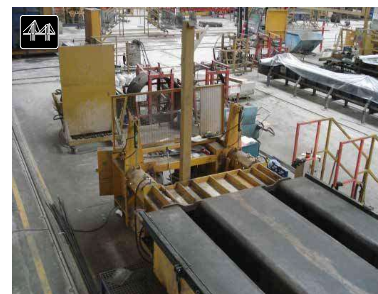
Форма 450 TN для производства панели покрытия типа 2T
