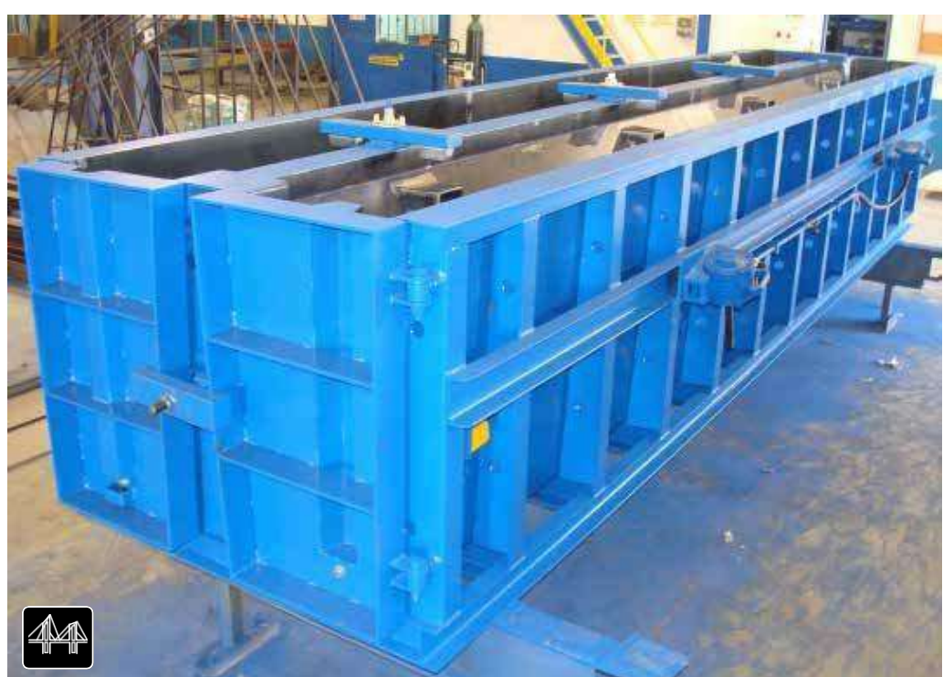
Форма для изготовления дорожных ограждений
