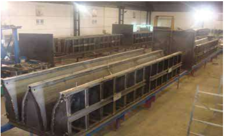
Формы для изготовления дорожных разделителей
