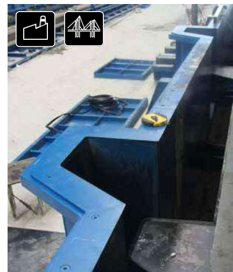
Расположение консоли колонны на форме
