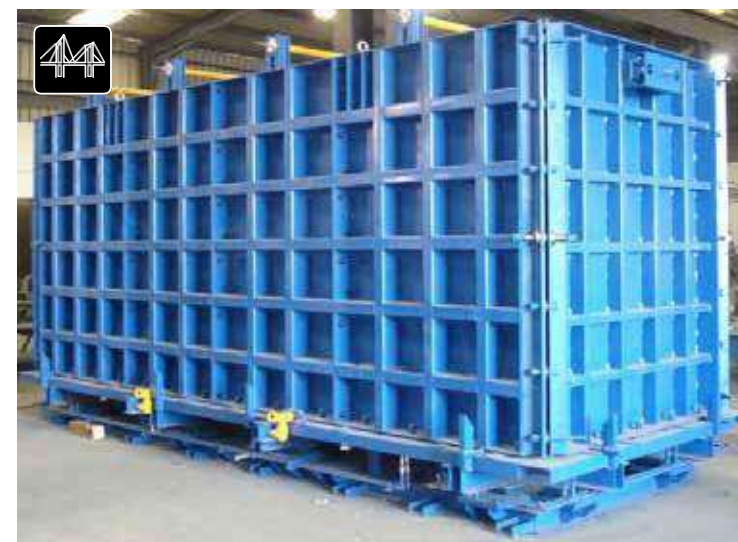
Форма для трансформаторных подстанций
