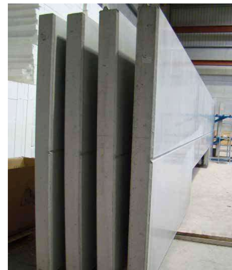
Стеновые панели со шлифованной внешней поверхностью
