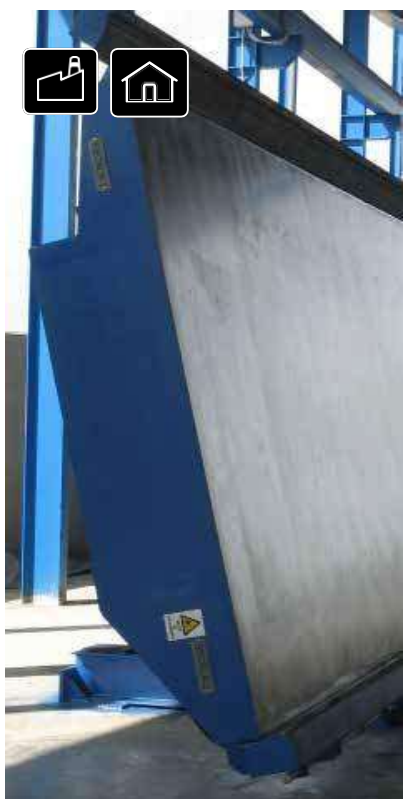
Поворотный стол в положении для съёма изделий
