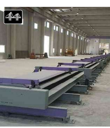
Форма 450 TN для производства панели покрытия типа 2T
