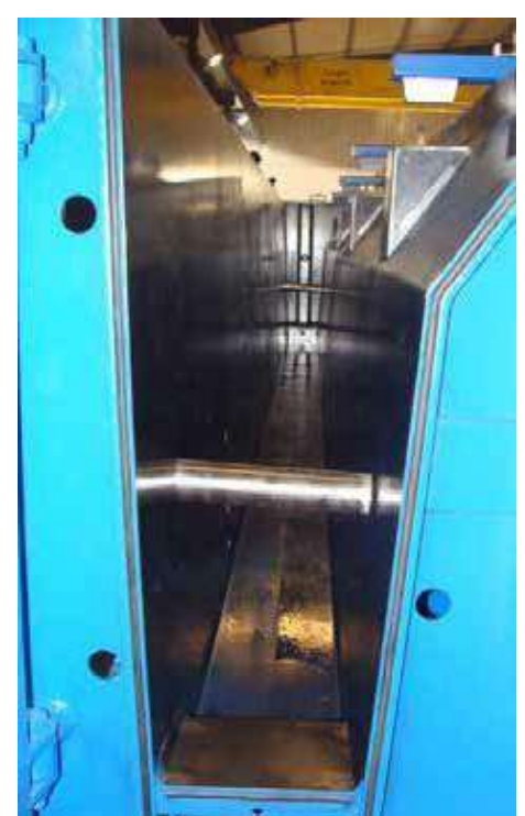
Форма для изготовления дорожных ограждений
