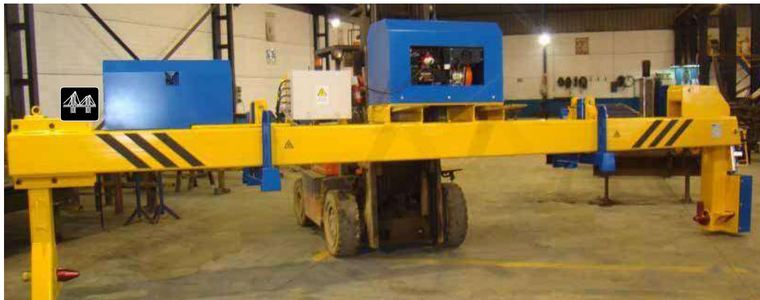
Подъёмная траверса для дорожных разделителей типа New Jersey
