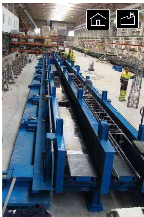
Двухручьевой стелла для изготовления колонн с автоматическим перемещением бортов
