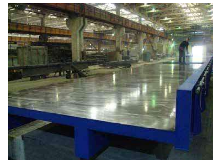
Лист металлопокрытия толщиной 10 мм с идеальной поверхностью
