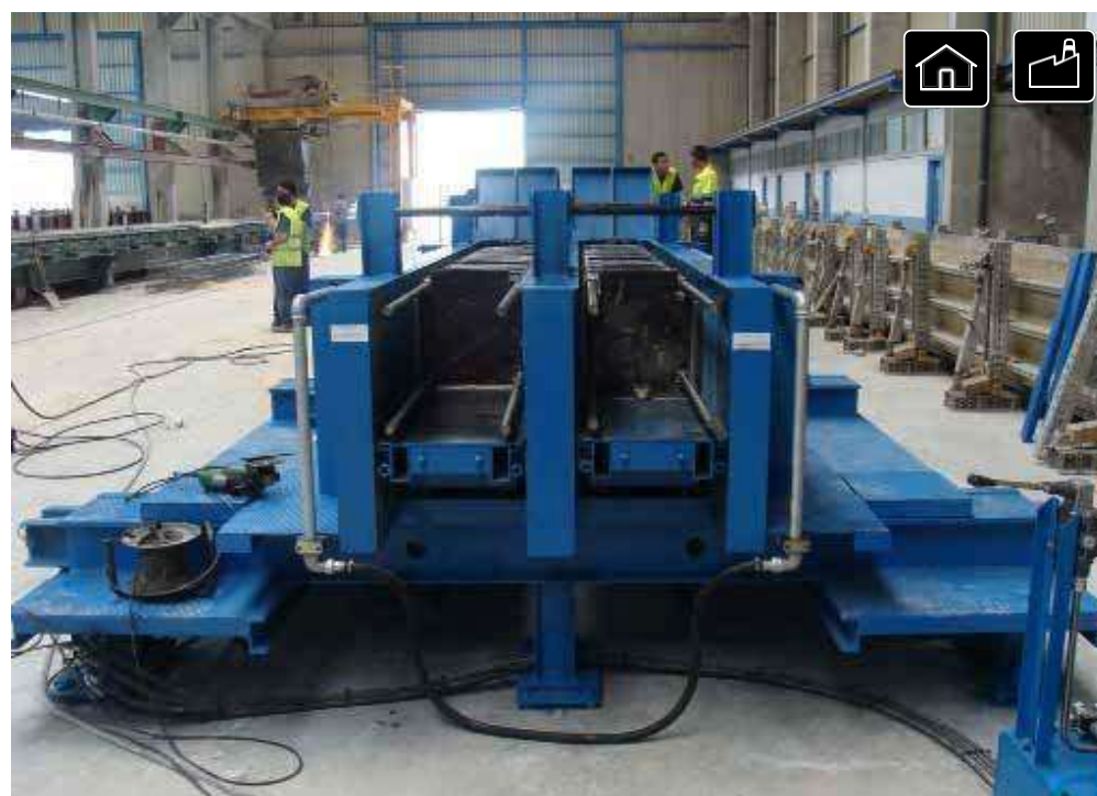
Двухручьевой стелла для изготовления колонн с автоматическим перемещением бортов
