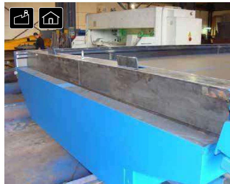
Подъёмные траверсы для панелей
