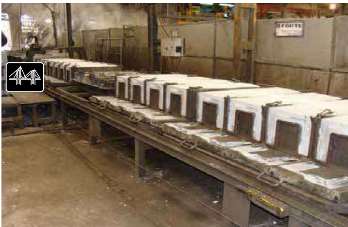
Перемещение форм с отформованными изделиями на пост ТВО
