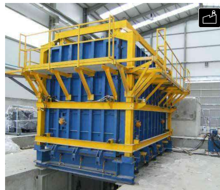
Форма для трансформаторных подстанций
