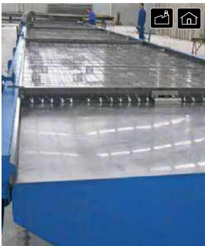
Укладка арматурного каркаса изделия
