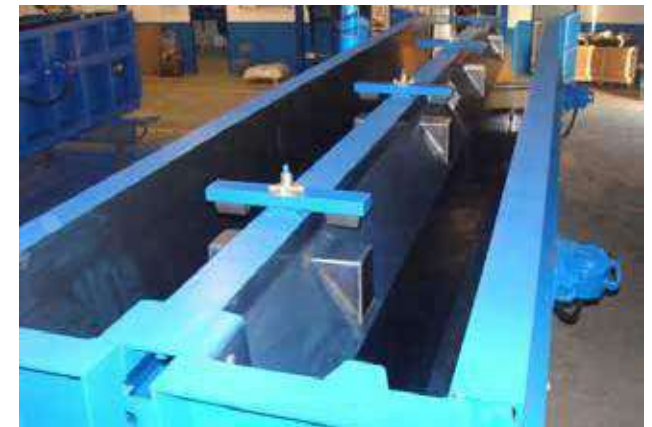
Форма для изготовления дорожных ограждений
