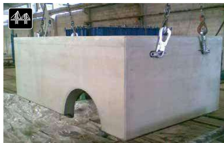
Форма для производства лотков
