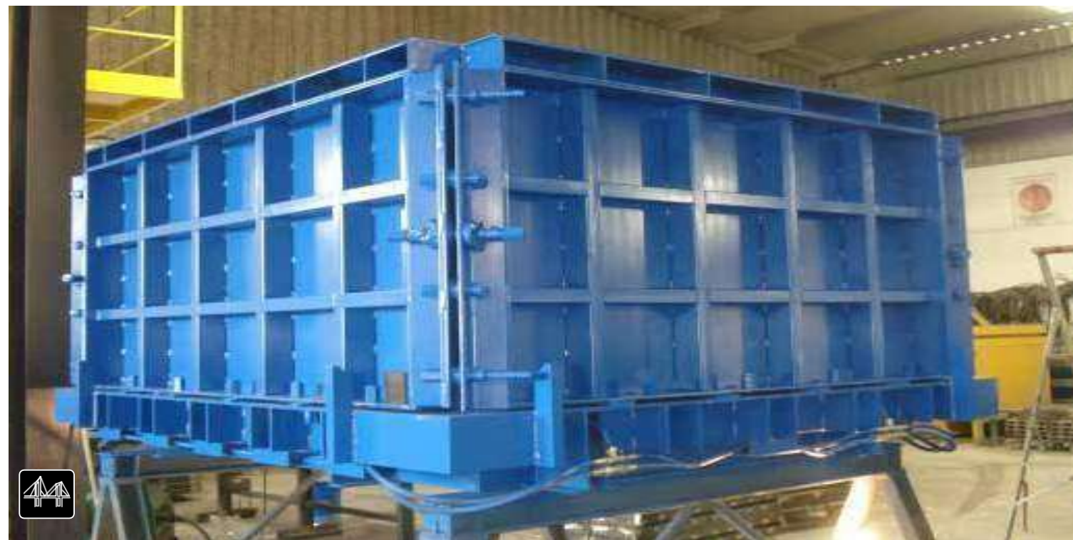
Форма для производства распределительного короба
