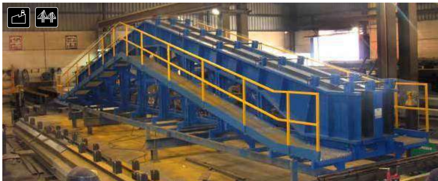
Оборудование для производства ферм производственных зданий сельскохозяйственного комплекса
