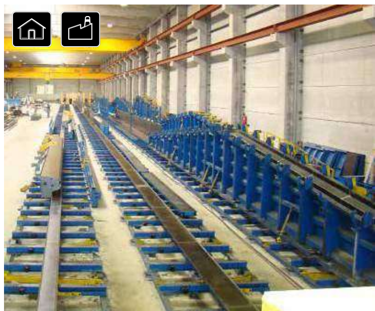
Установка из трех универсальных базовых дорожек для производства предварительно-напряженных
