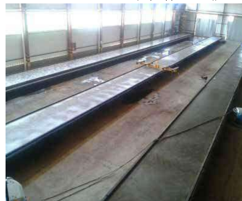
Стационарный формовочный стол длиной 60 м.
