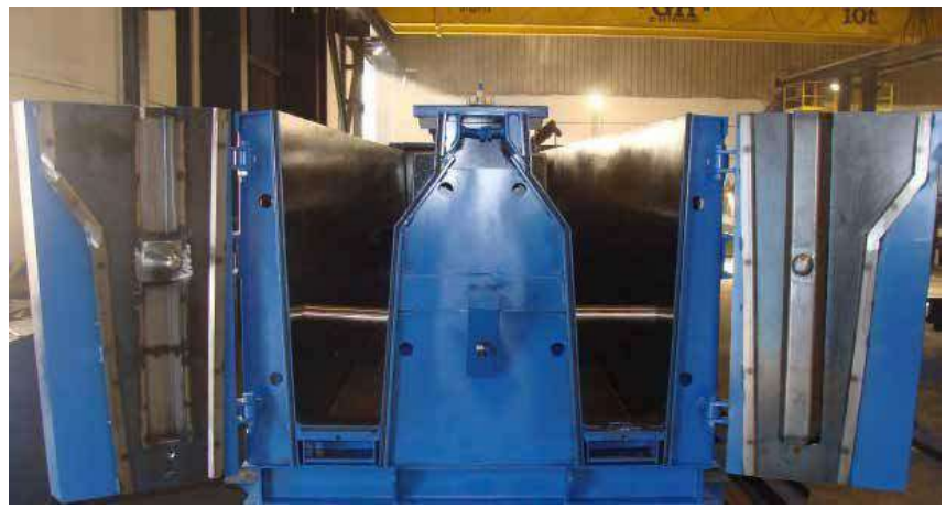
Форма для изготовления дорожных ограждений
