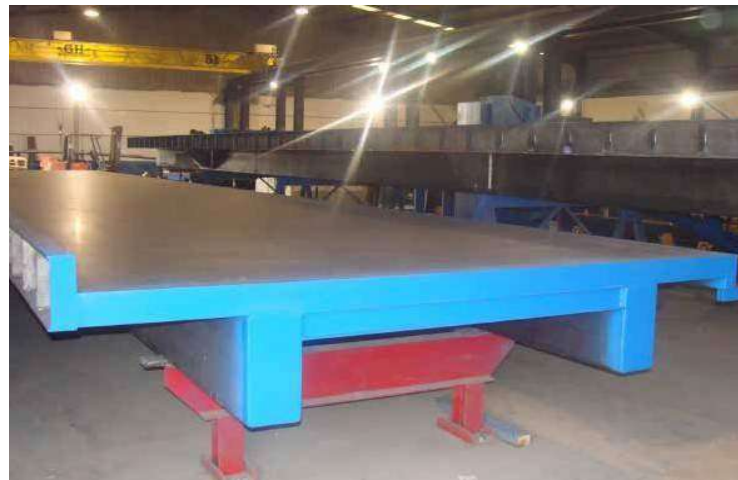
Стационарный формовочный стол длиной 60 м.
