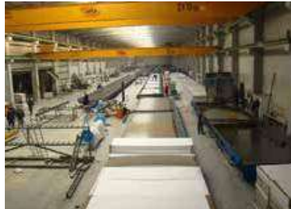
Производство панелей на поворотных столах
