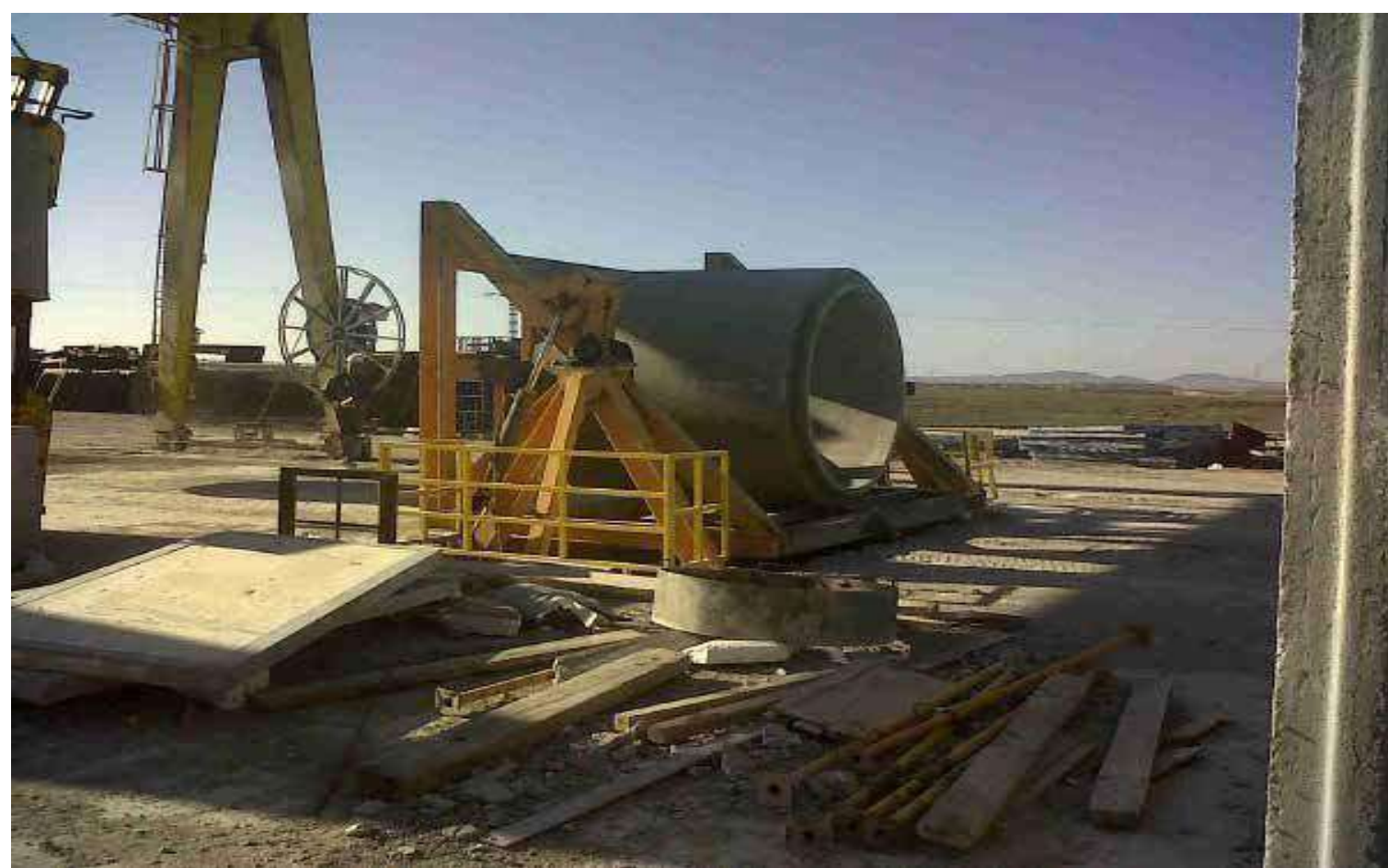
Кантователь изделий (угол 90°)
