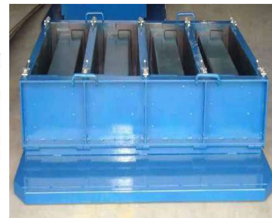
Форма для производства электротехнических лотков
