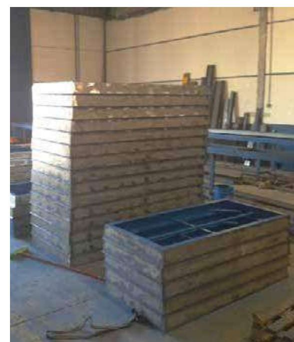
Опалубочные элементы дверных и оконных проемов
