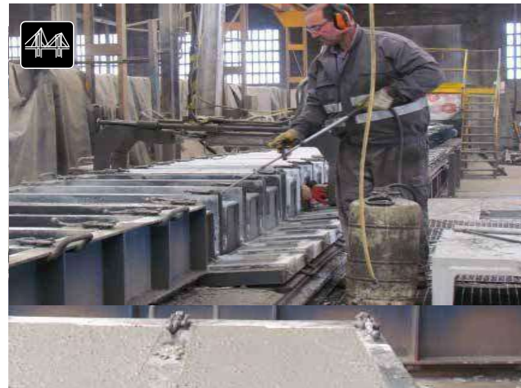
Готовые к разборке и чистке формы
